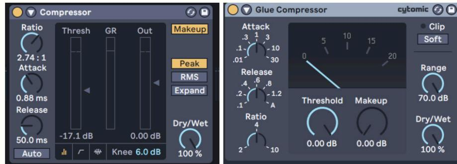
**Le rôle du compresseur est en soi très simple :** Réduire l'écart entre les moments les plus forts et les moments les plus calmes de nos pistes ou instruments. On dit à ce moment que l'on va contrôler "la dynamique" de notre morceau.
